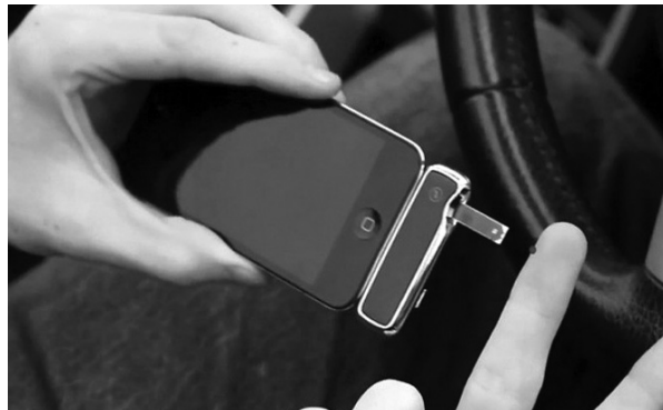
Рис. 6. iBGStar — глюкометр в телефоне
